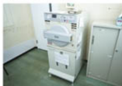
電気式オートクレーブ
